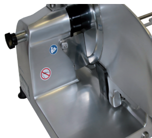
großer Abstand zwischen Messer und Motorblock und eine große Ablagefläche
